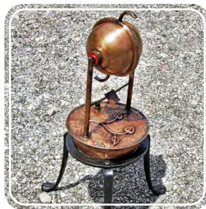
Moderní replika Heronova stroje - aeolipile
