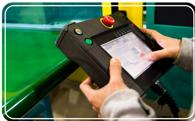
Pracownik korzystający z ręcznego programatora (teach pendant)
