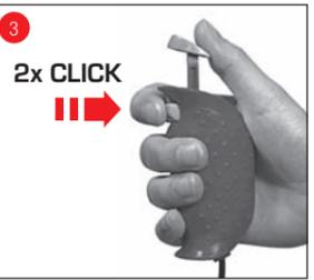
**D** Fahrzeug auf Bahn setzen, Weichenaste 2x drücken Abb. 1, Fahrzeug vorne anheben, zurücksetzen Abb. 2, Weichenaste 2x drücken Abb. 3. Programmierung wird durch Ton bestätigt. Alle Einstellungen sind gespeichert bis erneute Programmierung erfolgt.
